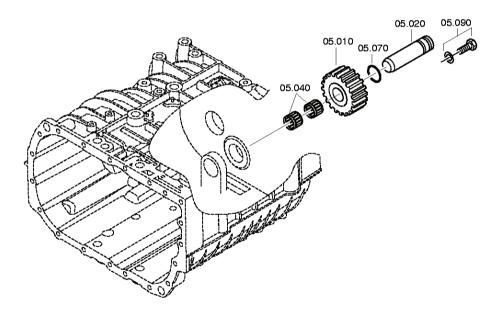
Plant: 032.06.01-1 GEAR SHIFT SYSTEM S 6-36 / GEAR SHIFT SYSTEM
